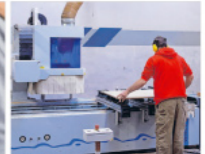
Bearbeitung von diversen Bauteilen aus Holz oder Kunststoff am CNC-Bearbeitungszentrum.
