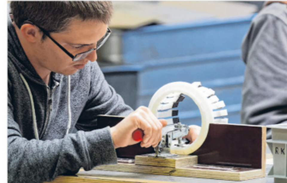
Montage von einzelnen Grüppengewerten für Rohrverbindungsstelle.
